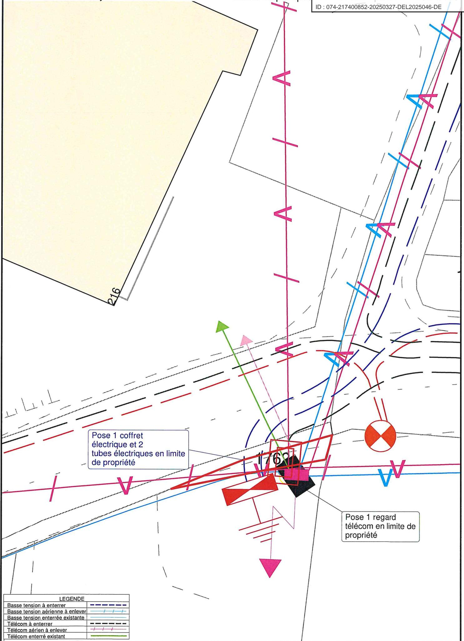
Pose 1 coffret électrique et 2 tubes électriques en limite de propriété
